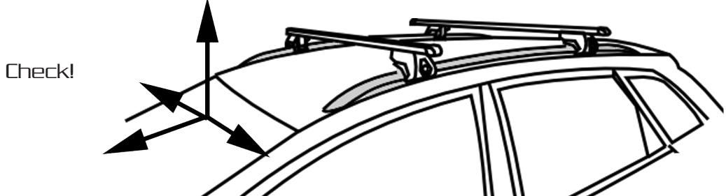
FR: Charge maxi 50 kg ne pas dépasser la charge maximale admissible par le constructeur du véhicule.
