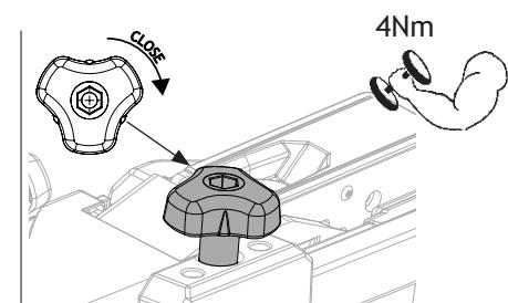
(FR) Avant de reprendre la route, replacer le porte-vélos en position droite et verrouillez le système. Assurez-vous que le système de basculement pour accéder au coffre soit bien serré avant de prendre la route, même pour des petits trajets.
