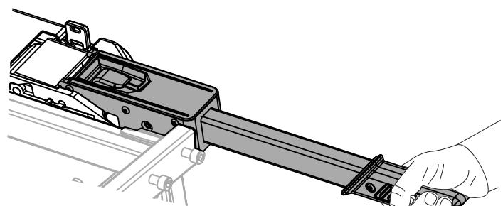
(FR) Pour augmenter la force de fermeture, tournez manuellement la vis d'1/4 de tour, puis abaissez le levier et vérifiez le serrage du produit, si nécessaire répétez l'opération jusqu'à trouver la fixation correcte.
