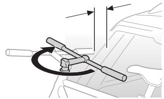
(FR) Dans le cas d'un véhicule dont le hayon est long, retirez toujours la clé avant de l'ouvrir.
