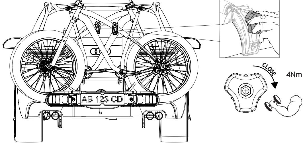
(FR) Selon le véhicule et la largeur du guidon, il est parfois nécessaire de le tourner. Fixer les bras au cadre du vélo et visser fermement la molette, pendant le trajet, vérifier toujours que les molettes soient bien serrées.
