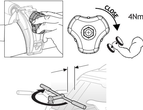
(FR) Selon le véhicule et la largeur du guidon, il est parfois nécessaire de le tourner. Fixer les bras au cadre du vélo et visser fermement la molette, pendant le trajet, vérifier toujours que les molettes soient bien serrées.
