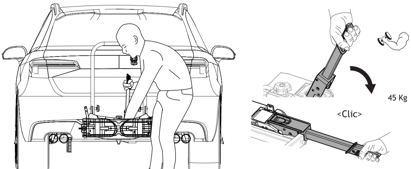
(FR) Positionner le système d'attache sur la boule d'attelage et baisser le levier jusqu'à entendre un "CLIC".
