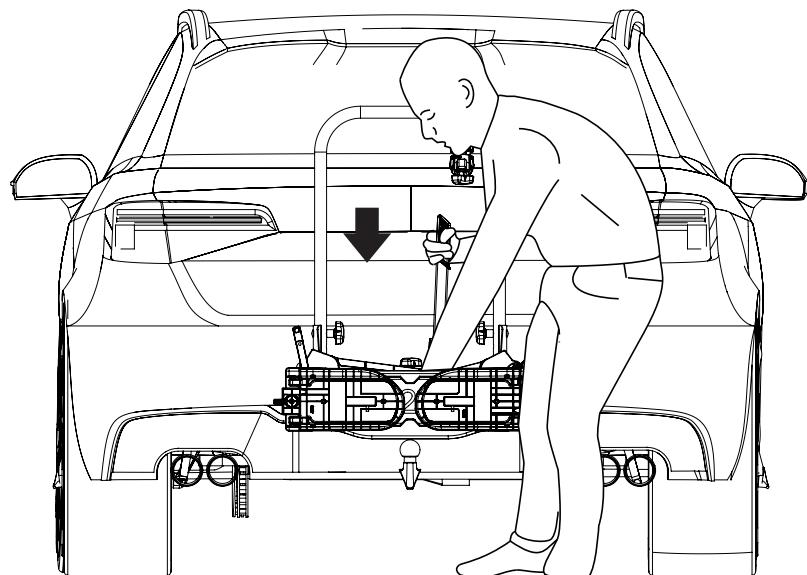
(FR) Tenir le porte-vélos à deux mains. Une main sur le levier, l'autre sur le cadre. Placer vous sur le côté droit du porte-vélos dans le sens du verrouillage du porte-vélos sur la boule d'attelage.
