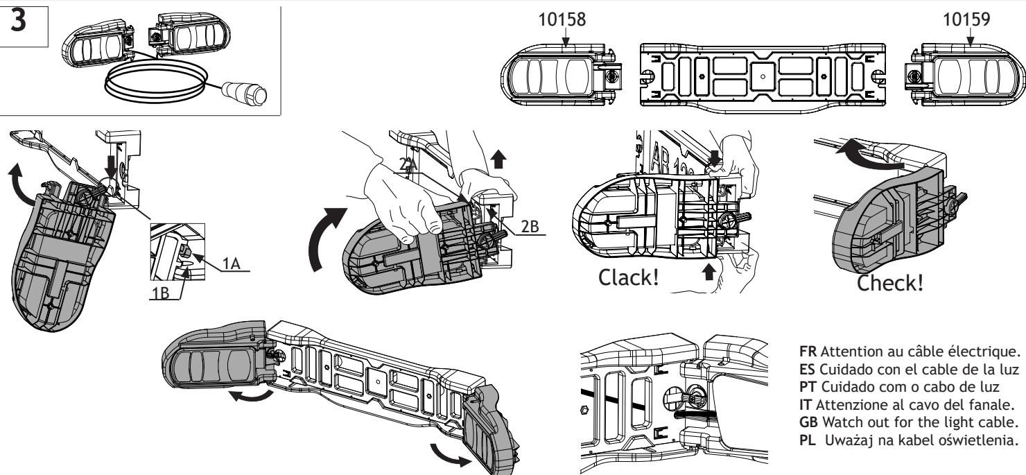
FR Positionner le feu comme sur la photo, insérer la goupille inférieure (1A) dans le trou correspondant, puis insérer la goupille supérieure (2A) dans le trou correspondant, puis vérifier le serrage et la bonne rotation du feu, répéter l'opération pour le deuxième feu.
