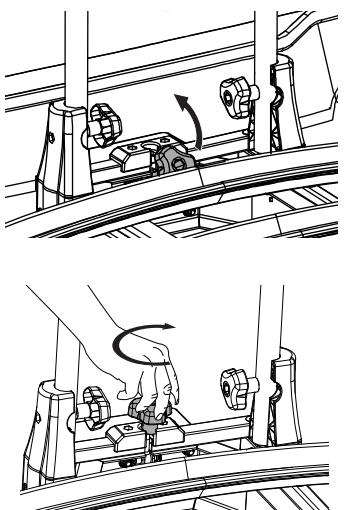
**FR** Pour incliner le produit et accéder au coffre de la voiture, dévissez le bouton placé au centre et déplacez-le de son siège, puis inclinez le produit en l'accompagnant jusqu'à la butée. Répétez l'étape inverse pour le remettre en place. Avant chaque utilisation, assurez-vous que le bouton est bien vissé.
