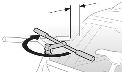
FR Selon le véhicule et la largeur du guidon, il est parfois nécessaire de le tourner. Fixez les bras au cadre du vélo, sécurisez-les en vissant fermement le bouton, pendant le trajet vérifiez toujours que les boutons sont correctement fermés.
