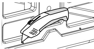
**FR** Veuillez noter que si votre plaque d'immatriculation ne s'insère pas dans la fente appropriée, il peut être nécessaire de couper les broches en plastique à l'aide d'un cutter.
