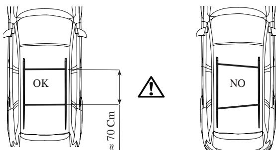
**FR :** Voiture avec prédisposition d'origine. **IT:** Vettura con punti di fissaggio. **ES:** Vehículo con punt de fijación de origen.
