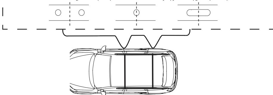
**FR :** Si le véhicule est équipé avec points de fixation d'origine, placer les barres de toit en correspondance d'entre eux.
