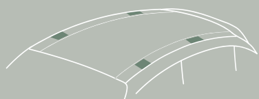
Predisposizione per vettura fix point | Fix point
